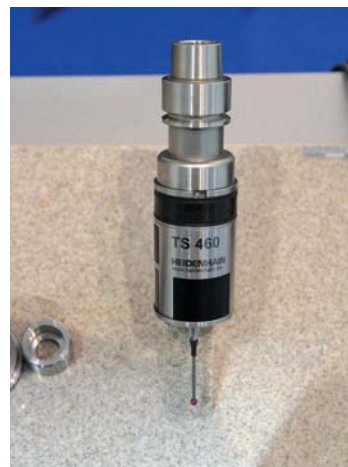
РИС. 2. ◀ Щуп для измерения заготовки TS460, работающий с радиоканалом
